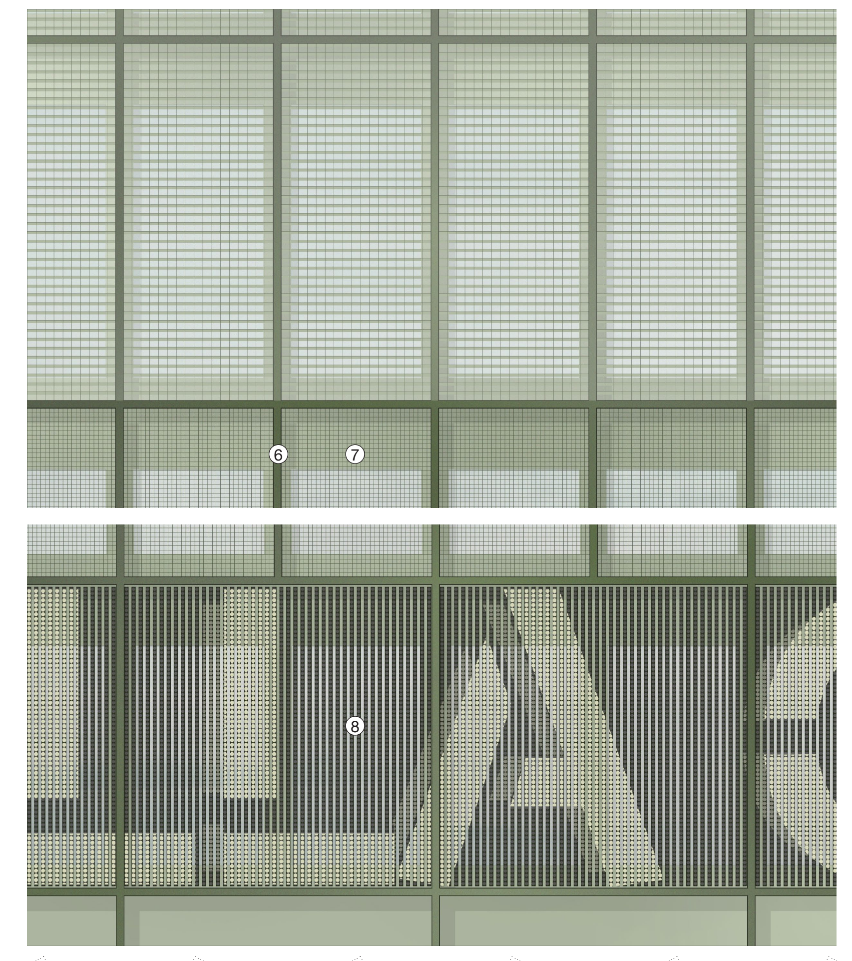
1. Solai in CLT 2. Travi secondarie in legno lamellare 3. Orditura principale in scalfati in acciaio verniciato 4. Struttura spaziale in acciaio verniciato RAL 6021 5. Irregolimento facciata interno in acciaio verniciato 6. Montanti e traversi estrusi in alluminio RAL 6021 7. Sistema modulare di pannellatura con applicata mesh metallica a diverse densità
